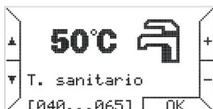
Toccando ancora il tasto ▽ si passa all'impostazione della temperatura dell'acqua sanitaria. Per facilitare l'immissione del valore, in basso a sinistra vengono visualizzati i limiti minimo e massimo previsti dalla caldaia.
