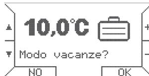
Premendo ancora il tasto ∇ viene visualizzato il terzo modo di funzionamento **VACANZE**.
