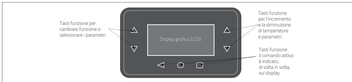
Per visualizzare i parametri ed interagire con il sistema di riscaldamento, il cronotermostato offre all'utente un display grafico LCD a matrice di punti ed una serie di tasti touch, oltre a un led posti sotto i tasti che fungono da guida e da segnalazione.
