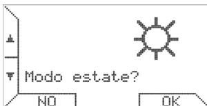
Premendo ancora il tasto ∇ viene visualizzato il quarto modo di funzionamento **ESTATE**.
