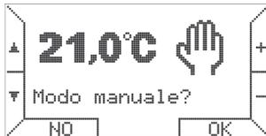
Premendo il tasto ∇ viene visualizzato il secondo modo di funzionamento **MANUALE**.
