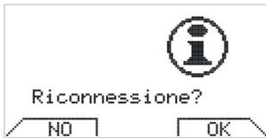
La funzione **Riconnessione**, invece, serve a forzare una riconnessione del cronotermostato in seguito a interventi hardware/software effettuati senza scollegare l'alimentazione sulla scheda di caldaia, nel caso in cui tali operazioni possano modificare la configurazione del sistema. Attivare la riconnessione equivale a staccare fisicamente il connettore di comunicazione dal cronotermostato e poi reinserirlo. **NON ESEGUIRE MAI TALE OPERAZIONE.**
