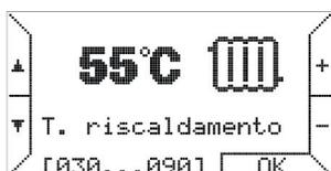
Toccando ancora il tasto ▽ è possibile impostare la temperatura massima del circuito di riscaldamento che presenta la stessa indicazione dei valori minimo e massimo. Questa impostazione rappresenterà il massimo valore che il set-point riscaldamento può assumere in caso di termoregolazione proporzionale o compensazione climatica.
