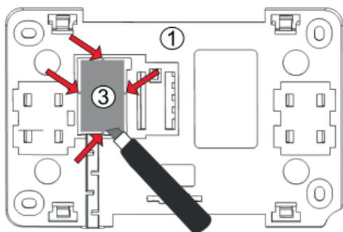
Utilizzando un utensile affilato, tagliare i fori in quattro punti del coperchio (3) per i terminali a vite.
