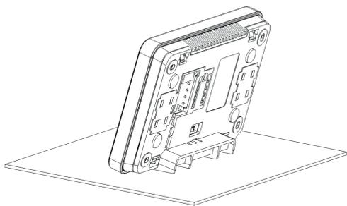
Praticare i fori nel muro e utilizzare viti (max. Ø 3 mm) per fissare il telaio di installazione nel punto selezionato sulla parete, mantenendo la sua posizione corretta. La distanza dei fori può essere determinata posizionando il telaio sul muro. Quindi fissare il pannello al telaio di installazione utilizzando i fermi.
