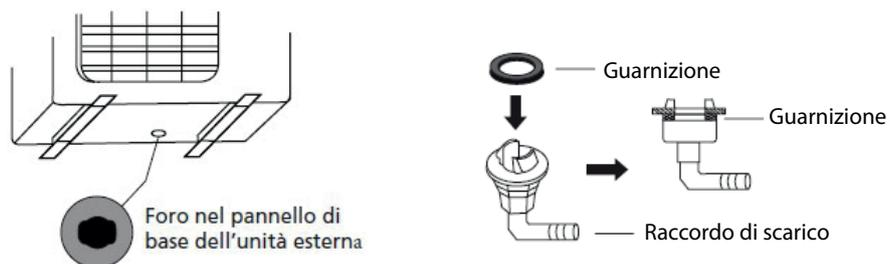
Ciascuna unità è provvista, sulla base del kit idronico (in corrispondenza del lato della batteria), di un foro per lo scarico di questa eventuale condensa che possa percolare dai tubi dell'impianto idraulico e dell'acqua che si forma a seguito del processo di sbrinamento. Essendo i tubi ben coibentati, la produzione di condensa è comunque minima.
