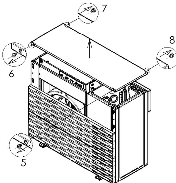
Rimozione copertura e pannello laterale:
