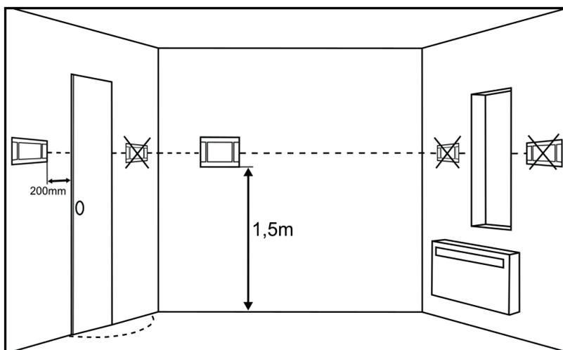
Al fine di ridurre l'interferenza della misurazione della temperatura da parte del pannello di controllo, evitare luoghi soleggiati con scarsa circolazione dell'aria, vicino ai dispositivi di riscaldamento e posti direttamente a porte e finestre (in genere ad almeno 200 mm dal bordo della porta).
