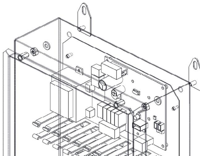
3. Collegare il kit esterno alla pompa di calore attraverso un cavo adatto alla comunicazione modbus (cavo non fornito, tipologia da usare 3x0,5 mm<sup>2</sup> twistato e schermato). Vedere la corrispondenza tra i morsetti della scheda utente e quelli del kit nella tabella seguente:
